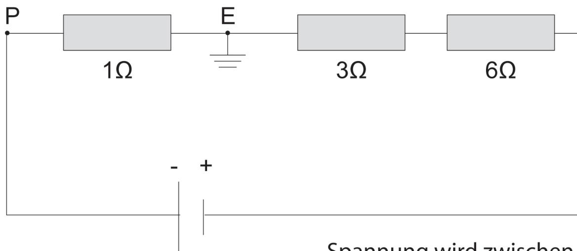
Spannung wird zwischen P und E gemessen
