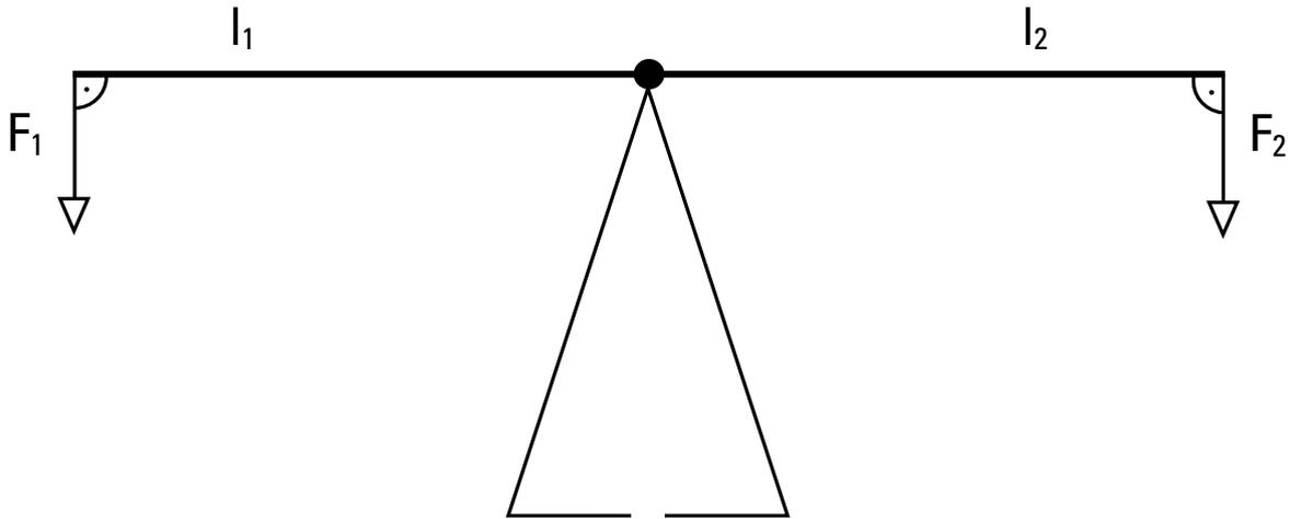
Der Balken behält seine Position, wenn das Produkt aus  $l_1$  und  $F_1$  gleich dem Produkt von  $l_2$  und  $F_2$  ist:
