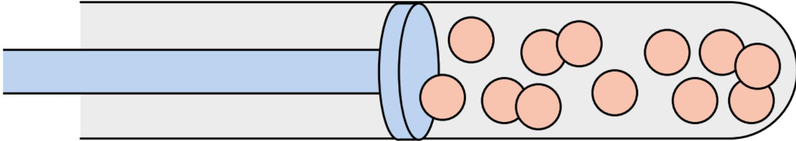
Steht der Kolben still, ist der äußere Druck (Kraft pro Kolbenquerschnittsfläche) gleich dem inneren Druck der Substanz.
