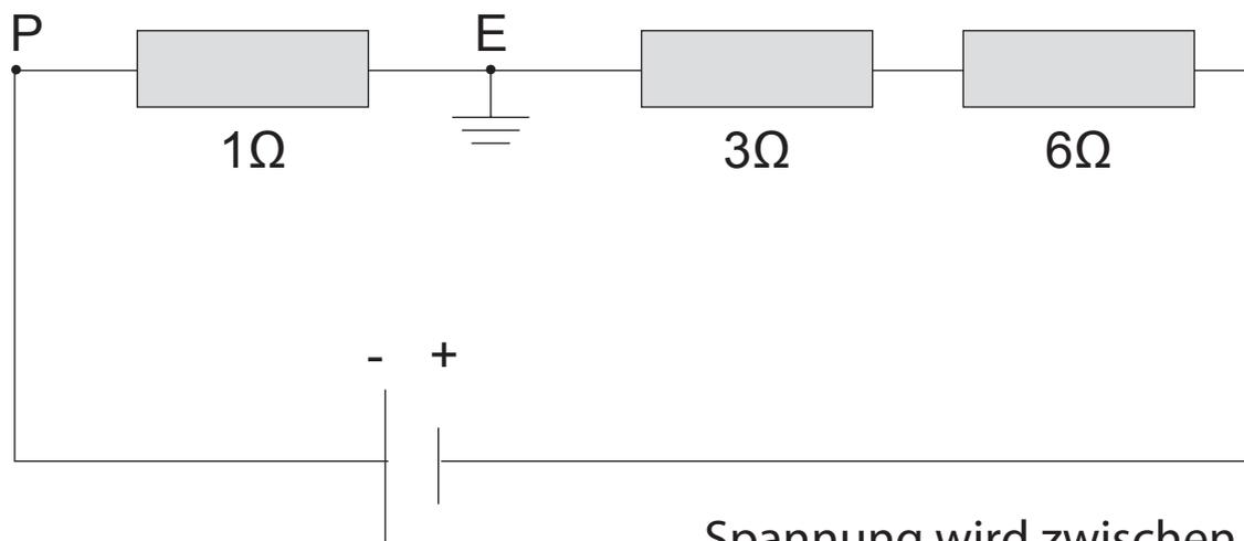
Spannung wird zwischen P und E gemessen
