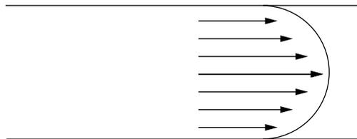
In der Mitte der Röhre strömt die Flüssigkeit am schnellsten (= am wenigsten Reibung), ganz außen am langsamsten. Laminar ist die Strömung, wenn alle unterschiedlich schnellen Flüssigkeitsschichten ohne Verwirbelungen nebeneinander strömen.
