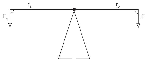
Der Balken behält seine Position, wenn das Produkt aus  $r_1$  und  $F_1$  gleich dem Produkt von  $r_2$  und  $F_2$  ist:
