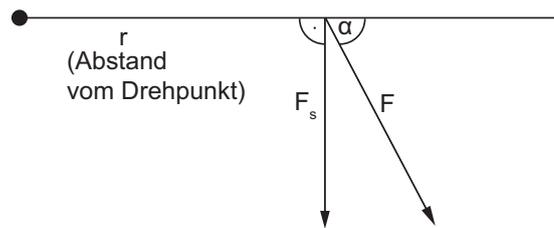
$$M = r \cdot F_s \text{ oder } M = r \cdot F \cdot \sin \alpha \text{ Einheit: [Nm]}$$
